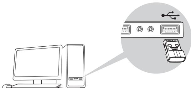
将网卡插入USB口，若弹出“新硬件安装向导”，点击“取消”。
